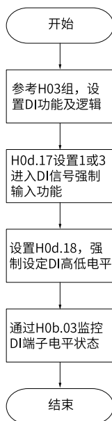
图1-6 DI信号强制输入设定步骤示意图
