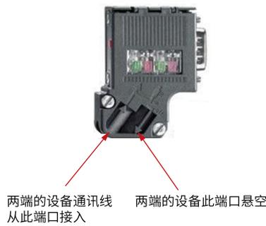
根据主站通讯波特率设置的不同，本DP扩展卡与PROFIBUS主站通讯导线的长度也有要求，须严格的按照SIEMENS的DB9接线标准限制通讯数据导线长度。波特率与导线长度要求见下表。
